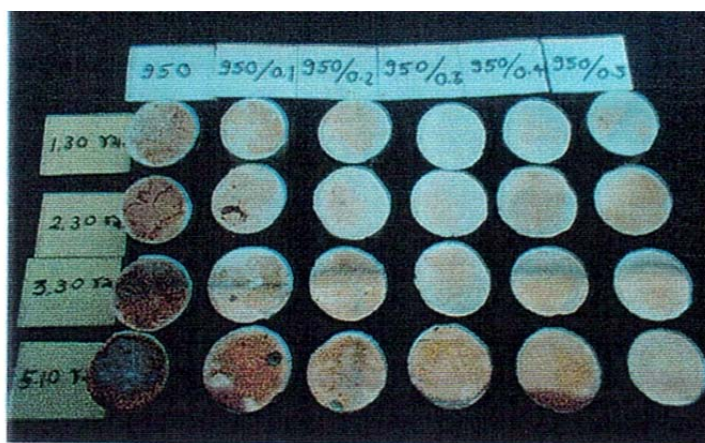
รูปที่ 4.2 ผิวชิ้นงานเงิน 95% ผสมซิลิคอน 0.1 - 0.5% และ ทองแดง 4.5 - 4.9 % ผ่านการทดสอบกันหมองในบรรยากาศ H_2S ที่เวลา 1.30 - 1.50 ชม. (18)
