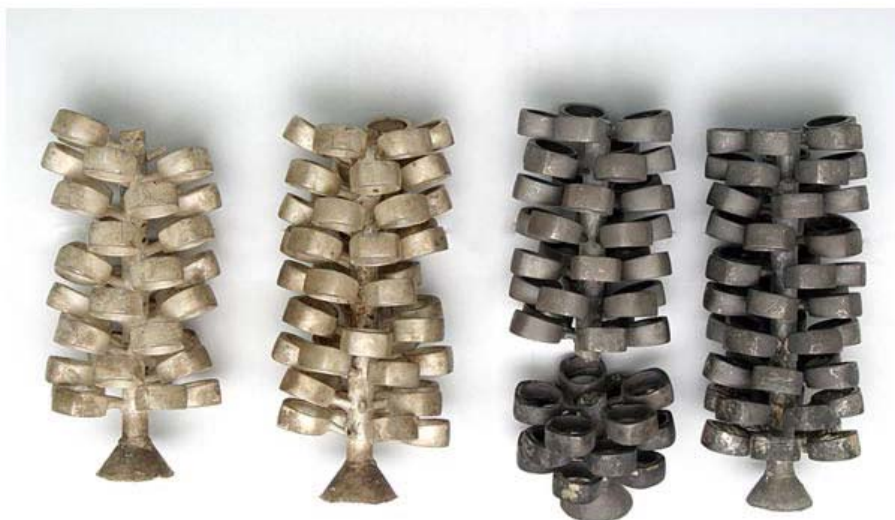
รูปที่ 2.6 แสดงการเปรียบเทียบ ฝักหลังการหล่อและล้างปูนระหว่างเงินสเตอร์ลิงผสม ทองแดงและซิลิคอน กับ เงินสเตอร์ลิงผสม ทองแดง สังกะสี ซิลิคอน (14)
