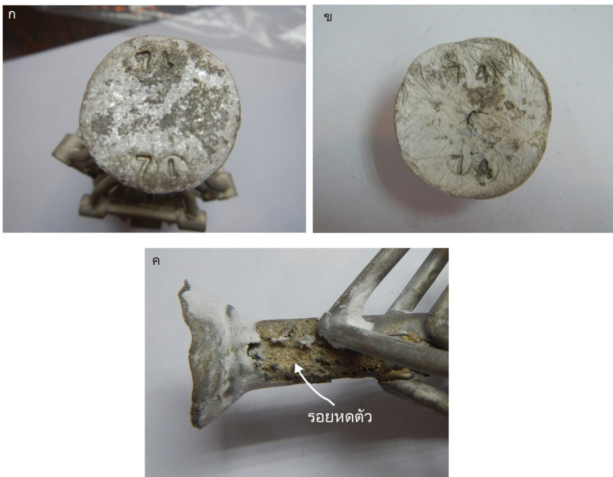
รูปที่ 4.16 ข ตัวอย่างฐานต้นเงินผสมอัลลอยร่วมกับมาสเตอร์อัลลอย ก) 7/1(\text{CuZnB0.1SiCa}) ข) 7/4(\text{CuZnB0.5SiCa}) ค) ฐานต้นเงิน 5/4(\text{CuAlB0.5SiCa}) มีรอยหดตัวแบบเดนไดรต์
