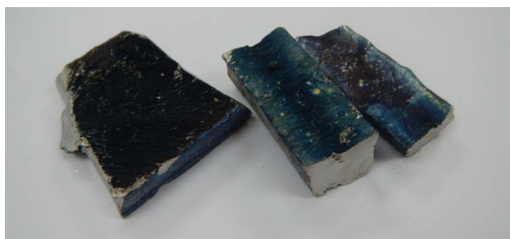
รูปที่ 4.15 ก มาสเตอร์อัลลอยทองแดงผสมซิลิคอนร่วมกับสารประกอบซิลิคอน ในอัตราส่วนCu10 Si 760 กรัม กับสารประกอบซิลิคอน 43 กรัมหลอมที่ 1130 องศาเซลเซียส
