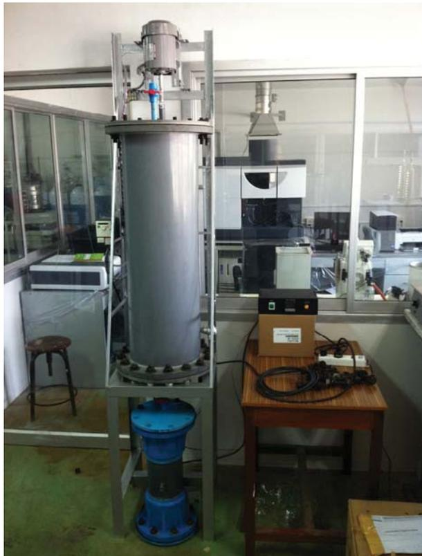
รูปที่ 3.4 ระบบต้นแบบกระบวนการปรับปรุงคุณภาพเถ้าลอยก่อนการแปรสภาพ (Acid-washing pretreatment)
