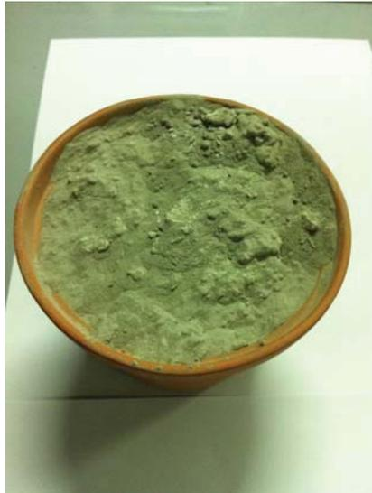
รูปที่ 4.5 ผลิตภัณฑ์ซีโอไลท์ที่สังเคราะห์ได้จากระบบต้นแบบ
