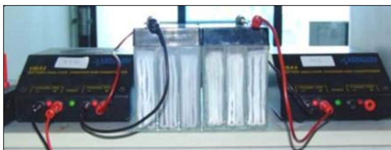
รูปที่ 13 เครื่องทดสอบแบตเตอรี่ UBA 4 ที่ใช้ในการทดสอบอัตราการคายประจุต่ำ (อัตราการคายประจุ 10 ชั่วโมง)
