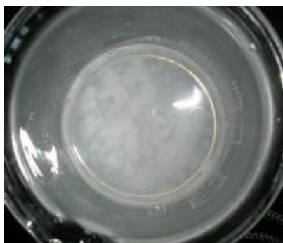
รูปที่ 28 เจลอิเล็กโทรไลต์ที่เตรียมจากฟุ้งซิลิกา 3 %w/v สารเติมแต่งพอลิแอคริลาไมด์ 0.03 %w/v ก) ด้านบน ข) ด้านข้าง
