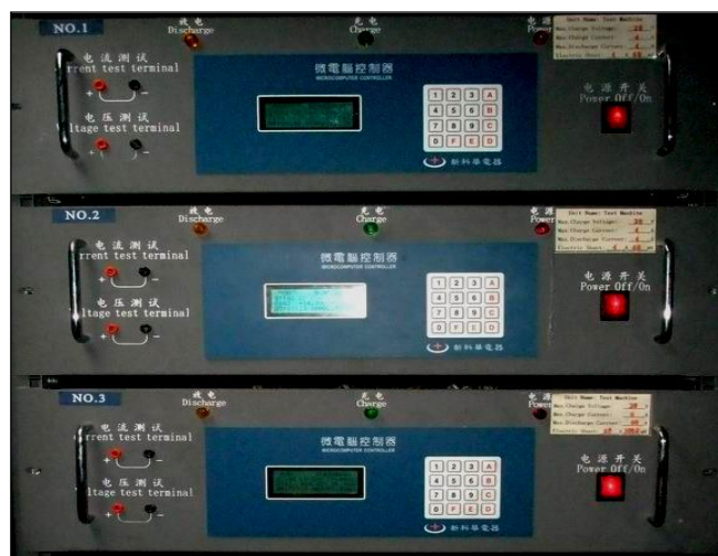
รูปที่ 14 เครื่องทดสอบแบตเตอรี่ Battery Charge/Discharge and Data Processing Control System User Manual Version 1.0 ที่ใช้ในการทดสอบอัตราการคายประจุสูง (อัตราการคายประจุ 1 ชั่วโมง)
