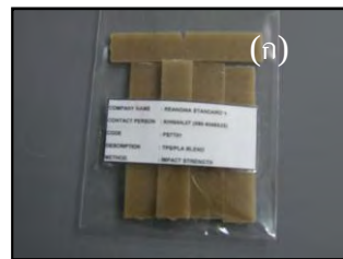
รูปที่ 2 ตัวอย่างชิ้นงานทดสอบของพอลิเมอร์ผสมระหว่าง TPS/PLA (ก) ชิ้นงานทดสอบ Impact Strength และ (ข) ชิ้นงานทดสอบ Tensile
