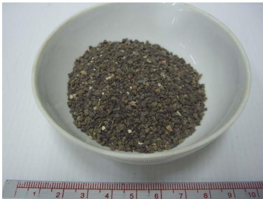
ภาพที่ 7 ลักษณะของตะกอนที่ผ่านการอบแห้งและคัดขนาดด้วยการร่อนผ่านตะแกรง ขนาดรูเปิด 2 มิลลิเมตร และล้างตะแกรงขนาดรูเปิด 600 ไมครอน
