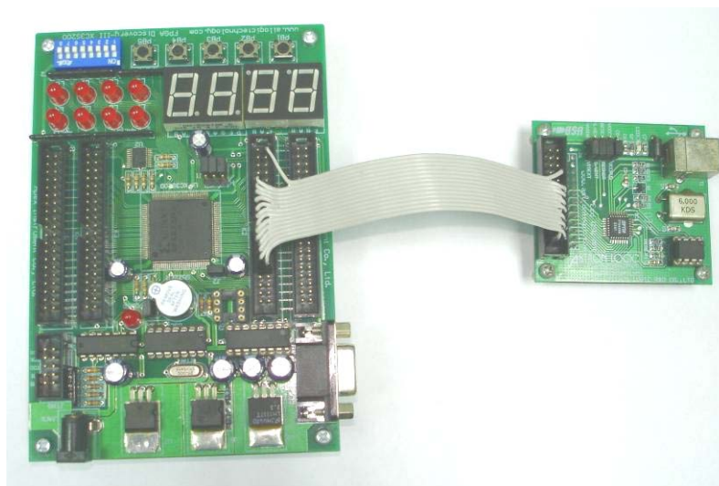
ภาพที่ 14 การเชื่อมต่อประสานบอร์ด FPGA และโมดูล USB
