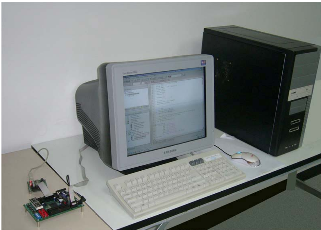
ภาพที่ 39 ระบบการเข้ารหัสถอดรหัสที่เชื่อมต่อกับเครื่องคอมพิวเตอร์
