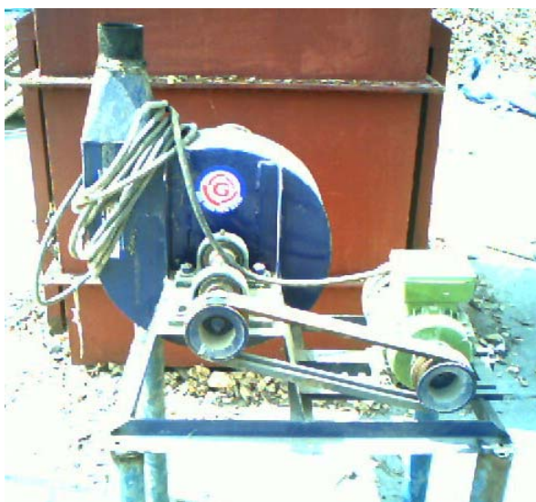
ภาพที่ 6 อุปกรณ์จ่ายลมชนิดเซนติฟูกัล (centrifugal blower)
