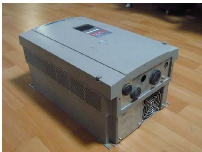
ภาพที่ 7 ลักษณะอุปกรณ์ปรับค่าความถี่แบบอินเวอร์เตอร์ (inverter)
