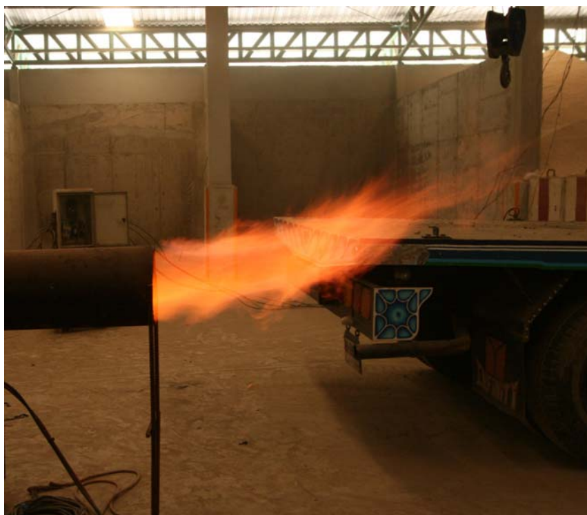
ภาพผนวกที่ ข5 ลักษณะเปลวไฟจากการติดไฟของก๊าซเชื้อเพลิง
