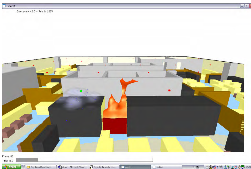
ภาพที่ 32 การทำงานของหัวกระจายน้ำดับเพลิงหัวแรกเมื่อเวลา 16.7 วินาที
