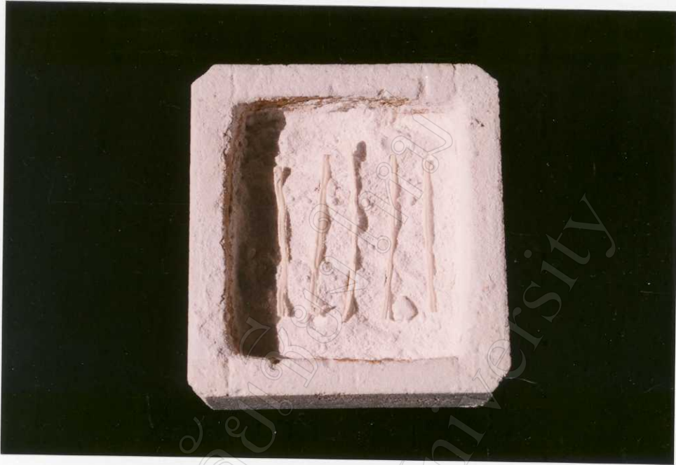
รูป 3.30 การจัดเรียงแท่งสาร PZT ในอิฐทนไฟเพื่อจะนำไปเผาซินเตอร์
