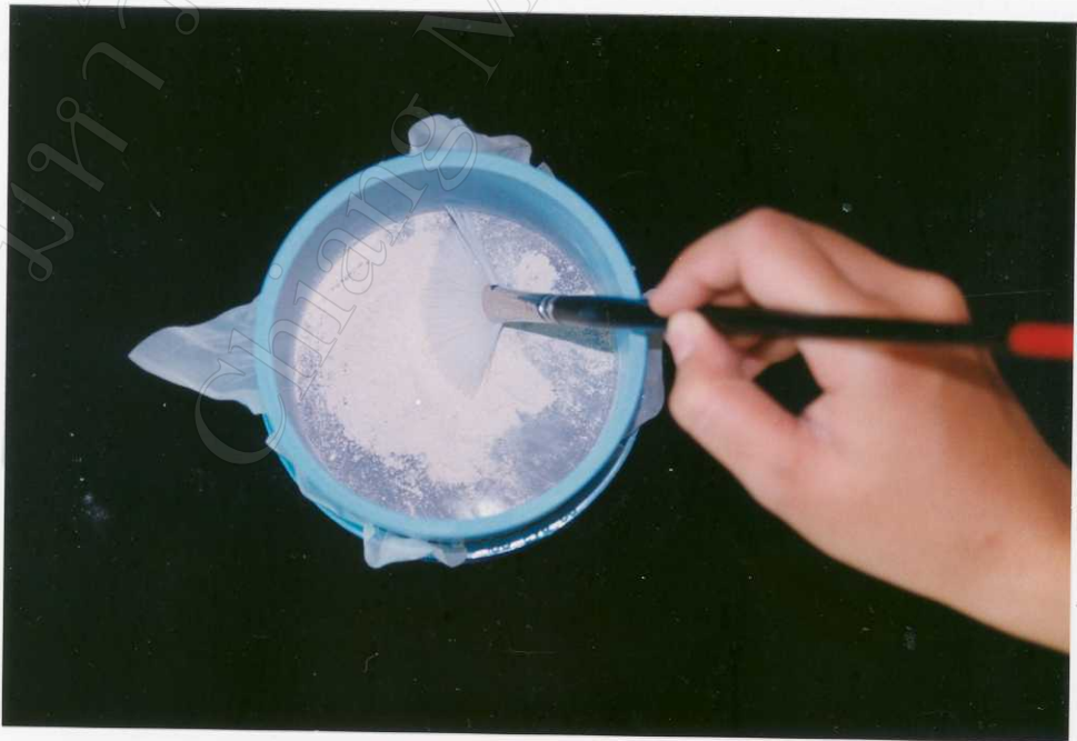
รูป 3.12 การคัดขนาดผงเซรามิกด้วยตะแกรงไนลอน
