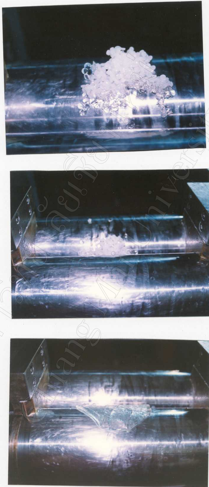
รูป 3.23 ขั้นตอนการเตรียมแผ่น PE
