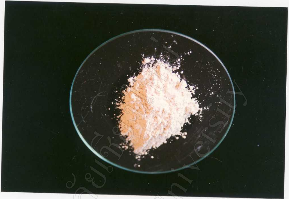
รูป 3.11 ผงเซรามิก PZT ที่ผ่านการบดด้วยเครื่องบด
