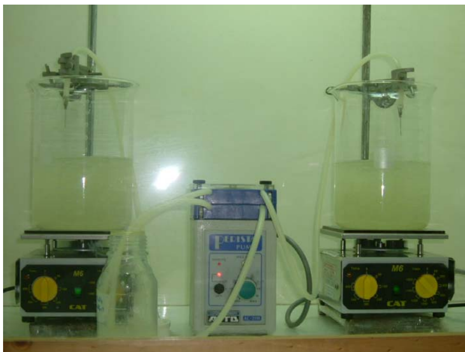
ภาพที่ 8 ขั้นตอนการหยดสารแขวนลอยลงในสารละลายโซเดียมแอลจีเนต
