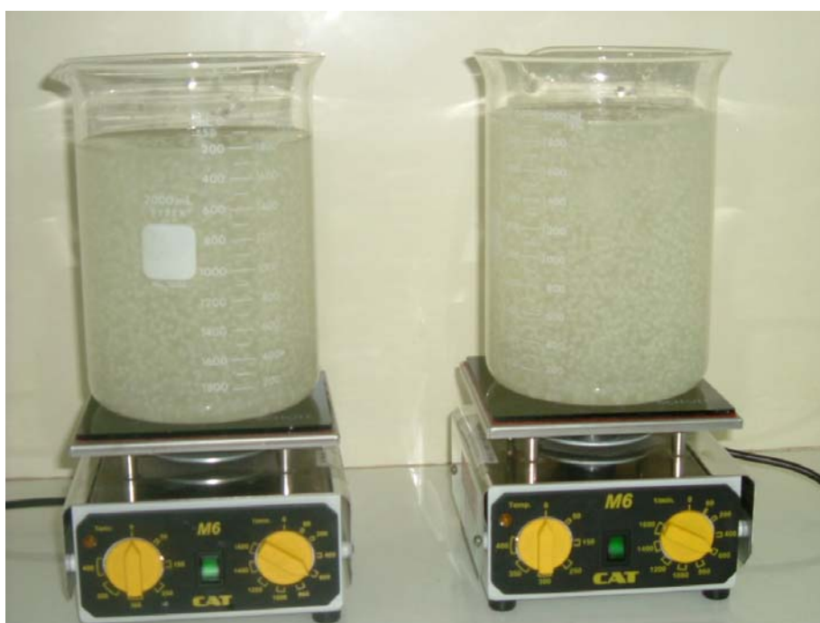
ภาพที่ 9 ขั้นตอนการทำแคปซูลเซลล์ตรึงในเยื่อแอลจีเนตให้แข็งตัว
