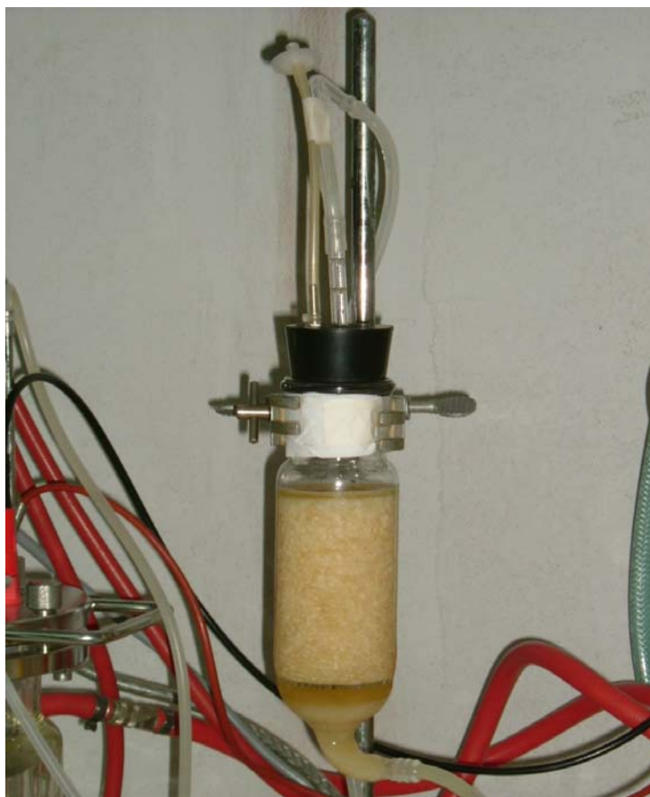
ภาพที่ 13 ถังปฏิกรณ์แบบ packed bed บรรจุเซลล์ตรึงในเยื่อแอลจิเนตขนาดเส้นผ่านศูนย์กลางและส่วนสูงเท่ากับ 6.04x10.5 เซนติเมตร
