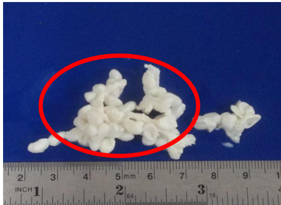
รูปที่ 27 ลักษณะการจับก้อนยางที่ได้จากการใช้สารละลาย \text{Ca}^{2+} ที่ความเข้มข้น 10,000 ppm
