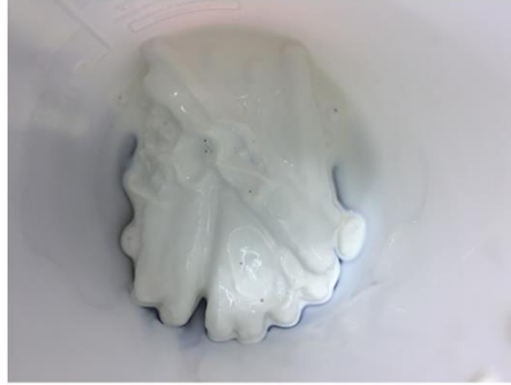
รูปที่ 73 ก้อนยางที่จับตัวบนแท่งเหล็กสนิม หลังแช่น้ำยางข้นเป็นเวลา 6 ชั่วโมง
