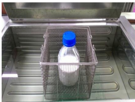
รูปที่ 18 ทดสอบสมมติฐานผลของอุณหภูมิของน้ำยางชั้น
