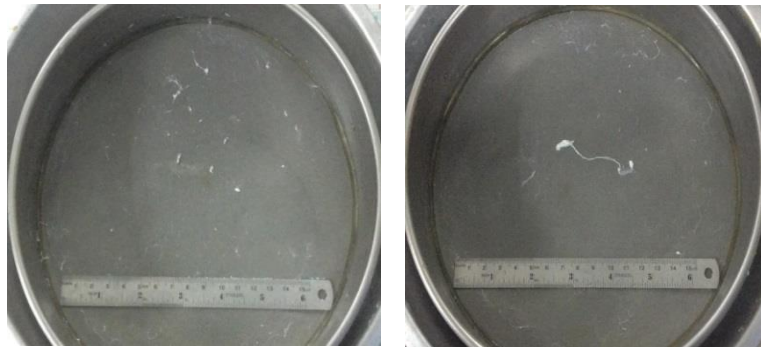
รูปที่ 41 ลักษณะการจับก้อนของเนื้องานจากสารละลาย Mg^{2+} ที่เวลาต่างๆ
