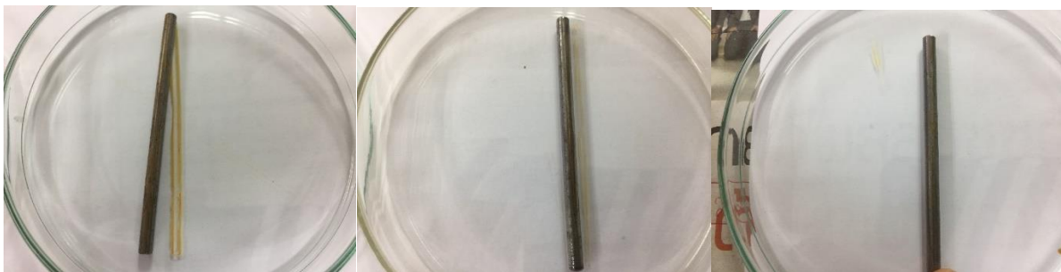
รูปที่ 61 ลักษณะเหล็กหลังสัมผัสน้ำและอากาศ
