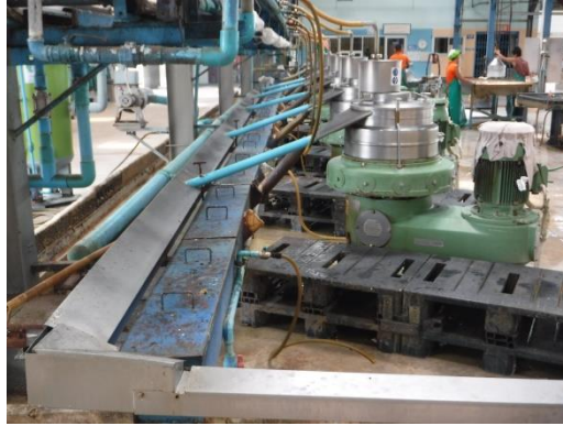
รูปที่ 2 เครื่องปั่นเหวี่ยงสำหรับผลิตน้ำยางข้นและรางขนส่งน้ำยางข้น
