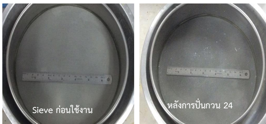
รูปที่ 22 ลักษณะของตะแกรง (sieve) ก่อนใช้งานและหลังใช้งานกรองน้ำยางที่ผ่านการปั่นกวน 24 ชั่วโมง
