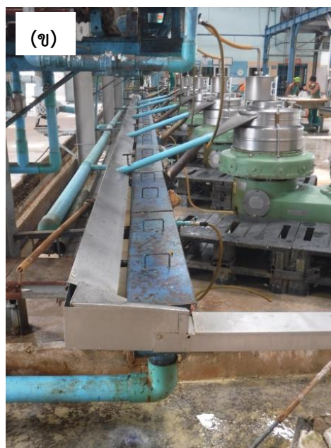
รูปที่ 10 รางน้ำยางข้น (ก) รางแบบเปิดโล่งของโรงงาน W จำกัด และ (ข) รางแบบที่มีฝาปิดชิดของโรงงาน C จำกัด
