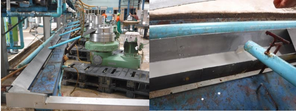
รูปที่ 3 เครื่องปั่นเหวี่ยงสำหรับผลิตน้ำยางข้นและรางขนส่งน้ำยางข้น
