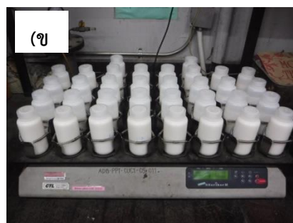
รูปที่ 17 ทดสอบสมมติฐานผลของการมีช่องว่างอากาศขณะขนส่ง (ก) บรรจุน้ำยางข้นที่ 50 75 และ 100% ของปริมาตรขวด และ (ข) การวางขวดบนเครื่องเขย่า
