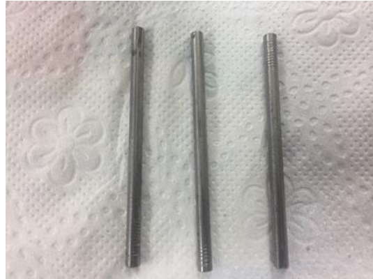
รูปที่ 54 ลักษณะแท่งเหล็กก่อนเกิดสนิม ตะปุดตัดหัว (เหล็กด้านซ้าย) ลวดเส้น (เหล็กแท่งกลาง) และลวดเชื่อม (เหล็กด้านขวา)
