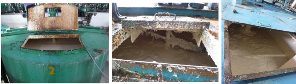
รูปที่ 8 บ่อพักน้ำยางชั้นที่ปนเปื้อนด้วยก้อนยางและสนิม
