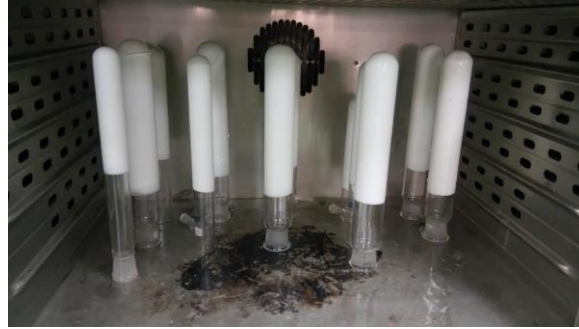
รูปที่ 81 แผ่นฟิล์มยางที่ได้จากกระบวนการขึ้นรูปด้วยวิธีจุ่ม (dipping process)
