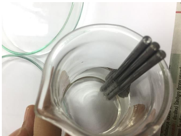
รูปที่ 58 การทดสอบเหล็กเกิดสนิม โดยเหล็กสัมผัสกรดและอากาศ
