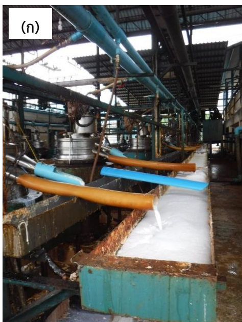
รูปที่ 10 รางน้ำยางข้น (ก) รางแบบเปิดโล่งของโรงงาน W จำกัด และ (ข) รางแบบที่มีฝาปิดชิดของโรงงาน C จำกัด
