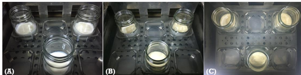
รูปที่ 21 น้ำยางชั้นใน shaker bath อุณหภูมิ 40 องศาเซลเซียส ที่เวลา (A) 0 ชั่วโมง (B) 12 ชั่วโมง และ (C) 24 ชั่วโมง
