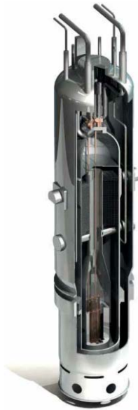
รูปที่ ค.14 (ก) โครงสร้างแต่ละโมดูลของเครื่องปฏิกรณ์ NuScale
