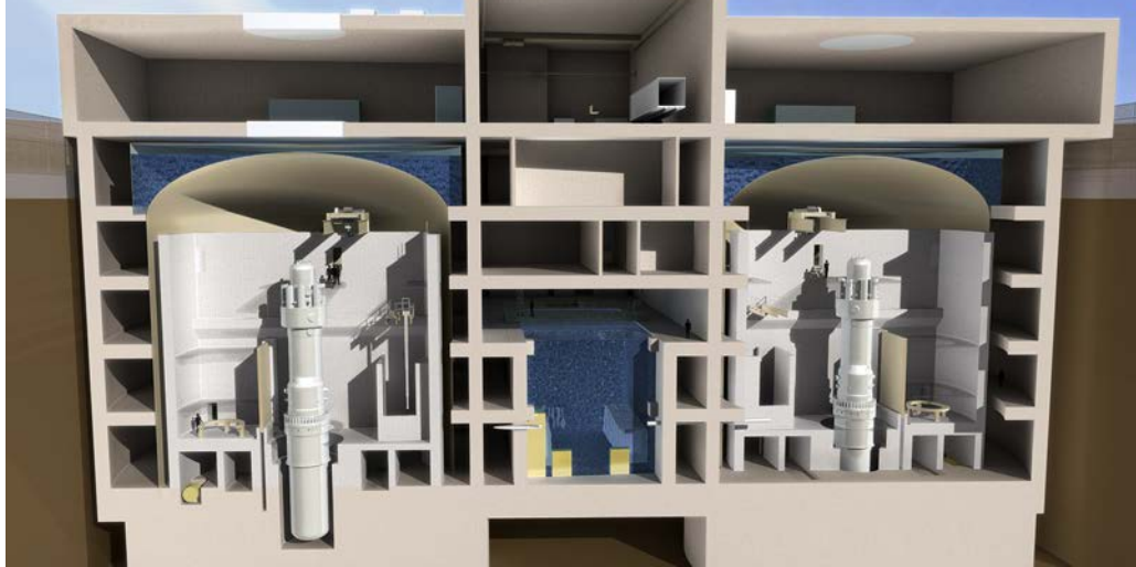
รูปที่ ง.20 เครื่องปฏิกรณ์คู่ (Twin-pack) ภายในอาคารปฏิกรณ์เดียวกัน
