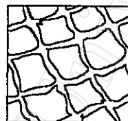
คอนกรีตเกิดการแตกร้าวแบบเปิด
