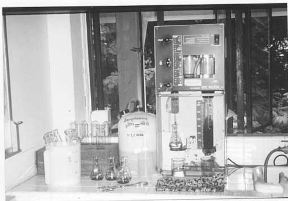
ภาพที่ 2ข อุปกรณ์สำหรับกลั่นแยกสารอินทรีย์ในไดโนเจนและแอมโมเนีย
