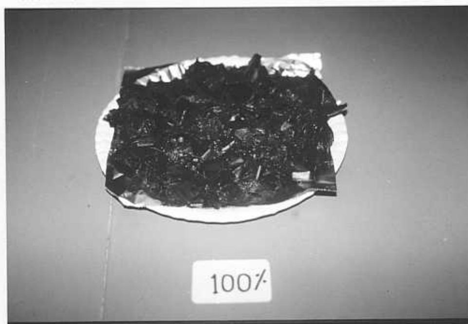
ภาพที่ 4.9 ลักษณะของก้านผักตบชวาจากถังปฏิริยาที่ใช้ น้ำเสียมีค่าความเข้มข้นสูงร้อยละ 100 ในวันที่ 10 ของการทดลอง
