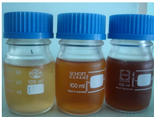
ภาพที่ 24 สารละลายไหมที่ได้จากการทดลองไฮโดรไลซิสรังไหมที่ความดันเริ่มต้นที่บรรยากาศ อุณหภูมิ 170, 200 และ 230 องศาเซลเซียส เมื่อใช้เวลาในการไฮโดรไลซิส 30 นาที
