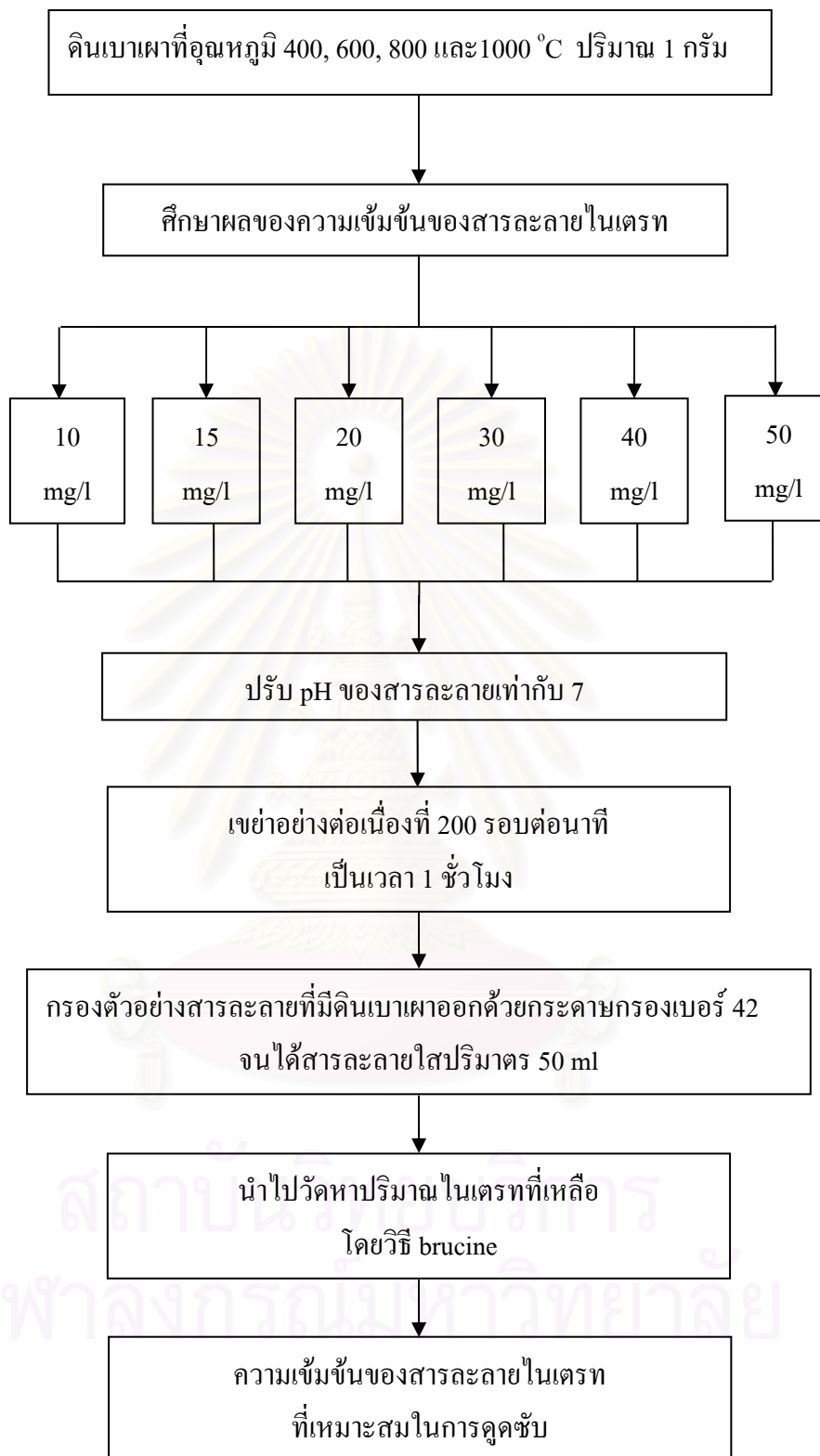
ภาพที่ 3.5 ขั้นตอนการศึกษาผลของความเข้มข้นของสารละลายไนเตรทที่มีต่อการดูดซับ โดยดินเบาเผาที่อุณหภูมิ 400, 600, 800 และ 1000 °C
