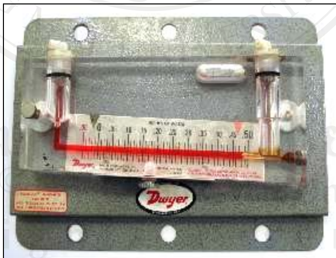
รูปที่ 3.9 อุปกรณ์วัดความดันอากาศตกคร่อมหม้อน้ำรถยนต์
