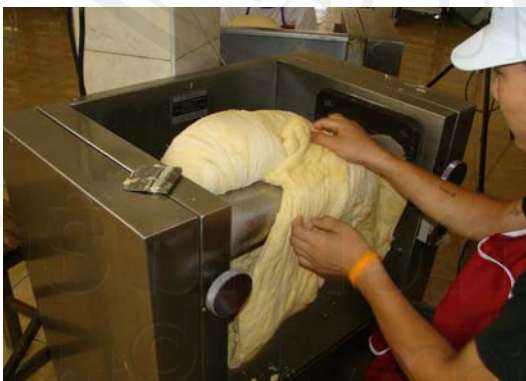
รูปที่ 4.4 แสดงการไล่อากาศในแป้ง
