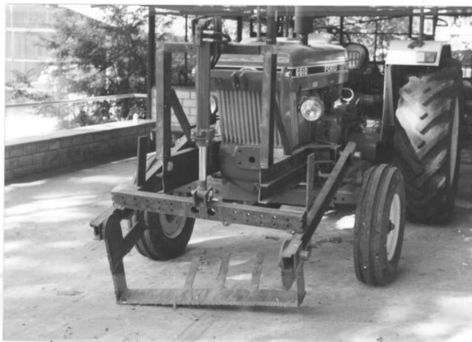
ภาพที่ 3.3 แสดงหัวขุดมันสำปะหลังรูปสี่เหลี่ยม
