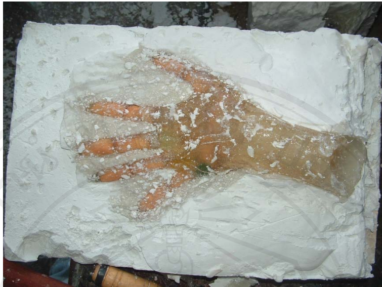
ภาพประกอบที่ 10 หล่อน้ำตาลในแม่พิมพ์(ถอดพิมพ์แล้ว)
