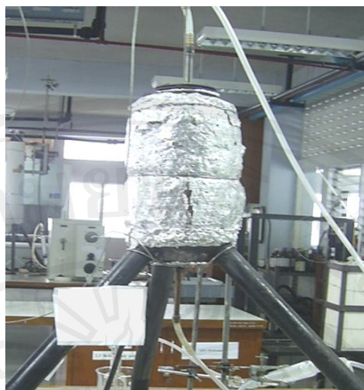
รูป 2.9 เครื่องปฏิกรณ์ตัวเร่งปฏิกิริยา (Catalytic reactor)
