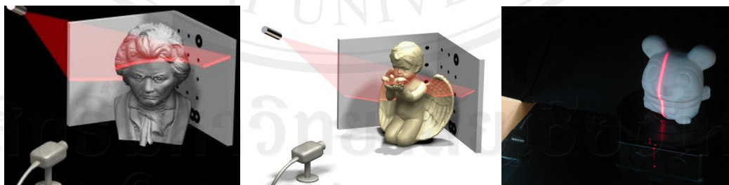
รูปที่ 1.2 ลักษณะแสงเลเซอร์ที่ฉายไปกระทบพื้นผิวของวัตถุ
