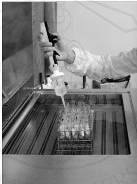
ภาพ 18 การเติมนเมทานอลความเข้มข้นร้อยละ 100 ลงไปให้ใกล้เคียงระดับสารเริ่มต้น ตลอดระยะเวลาที่ต้ม
