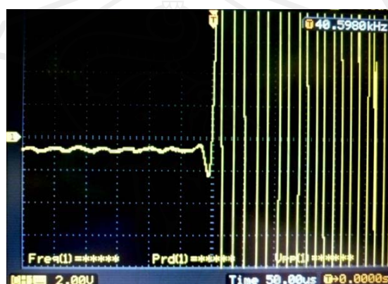
ข. คลื่นอัลตราโซนิกที่มีความถี่ 42 kHz วัดจากเครื่องดิจิตอลออสซิลโลสโคป
