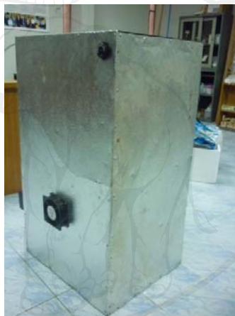
ก.เครื่องผสมน้ำมันอิมัลชันด้วยคลื่นอัลตราโซนิกความถี่ 28 kHz
