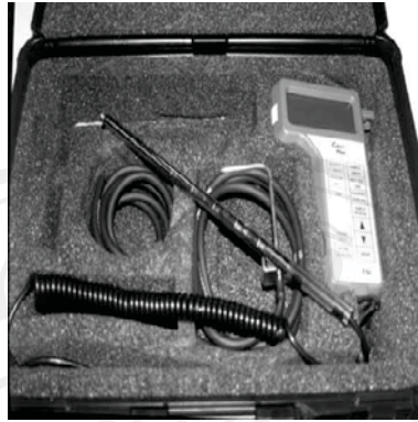
รูป ก 1 เครื่องวัดความเร็วลม (Anemometer, TSI Incorporated : Model 8385-M-GB)
