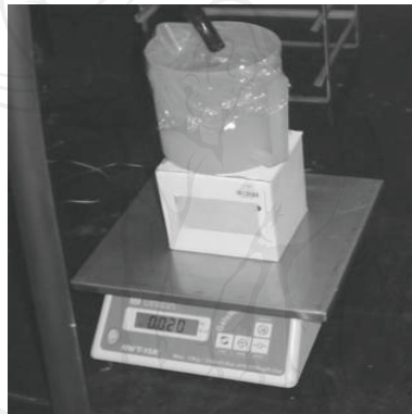
รูป ก 5 เครื่องชั่งน้ำหนักดิจิทัลความละเอียด 0.005 กิโลกรัม
