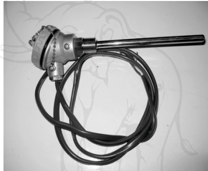
รูป ก 11 เซ็นเซอร์อุณหภูมิ Platinum RTD Class B แบบสามสายความเที่ยงตรง \pm 0.3^{\circ}\text{C} at 0^{\circ}\text{C}
