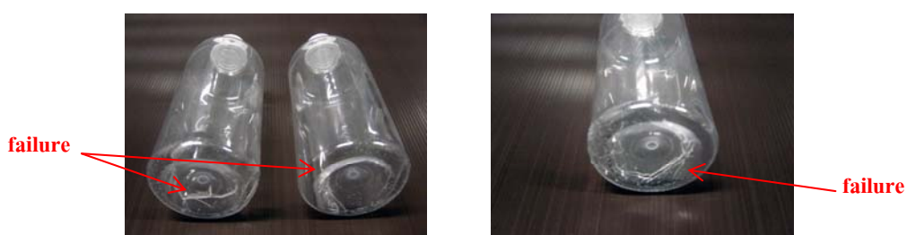
ภาพที่ 49 ขวดทดสอบ ก ที่ถูกทดสอบปล่อยตกการแตกจะเกิดขึ้นที่ก้นขวด
