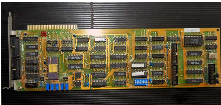
ภาพที่ 13 การ์ด A/D รุ่น PCL-812PG ของบริษัท Advantech, USA. รับได้ 16 ช่องสัญญาณ และส่งได้ 2 ช่องสัญญาณ
