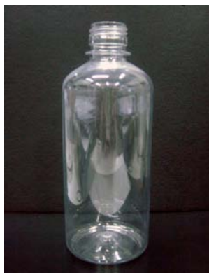
ภาพที่ 9 ขวดทดสอบ ก ความจุ 0.5 ลิตร น้ำหนัก 0.032 กิโลกรัม ผลิตจากวัสดุ PET
