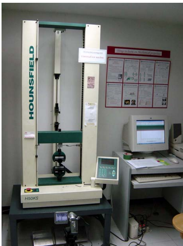
ภาพที่ 12 เครื่องดึงทดสอบ (tensile test machine) รุ่น H50KS ของบริษัท Tinius Olsen (HOUNSFIELD), USA.
