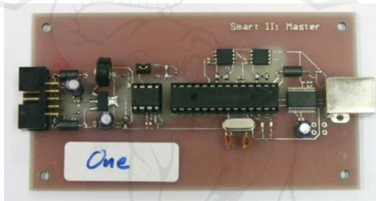
รูป 4.2 ภาพแผ่นวงจรพิมพ์และอุปกรณ์ของโหนด Master
