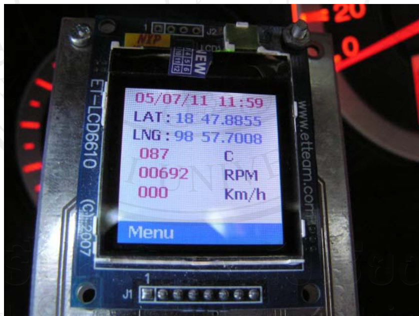
รูป 4.31 ภาพโหนด HMI ขณะแสดงผลข้อความตำแหน่ง ข้อความฐานเวลาจริงและข้อมูลสถานะ ของรถยนต์บางส่วน
