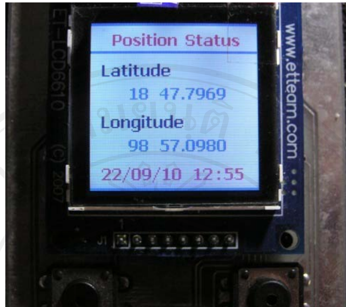
รูป 4.30 ภาพการทดสอบโหนด HMI โดยให้แสดงข้อมูลจากข้อความตำแหน่ง และข้อความฐานเวลาจริง
