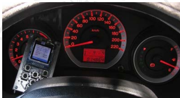
รูป 4.38 ภาพทดสอบการทำงานของระบบ OMD Client ในรถยนต์#4
