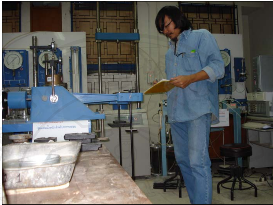
รูป ง-6 ทดสอบการอัดตัวภายใต้น้ำมีติเดียวในห้องปฏิบัติการ
