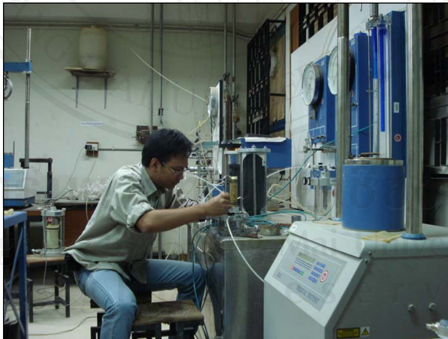
รูป ง-7 ทดสอบแรงอัดสามแกนในห้องปฏิบัติการ
