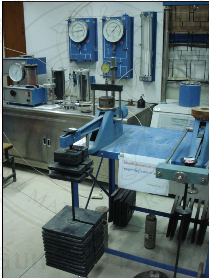
รูป ง-8 ตัวอย่างดินและชุดอุปกรณ์ทดสอบการอัดตัวคายนํ้ามิติเดียวในห้องปฏิบัติการ
