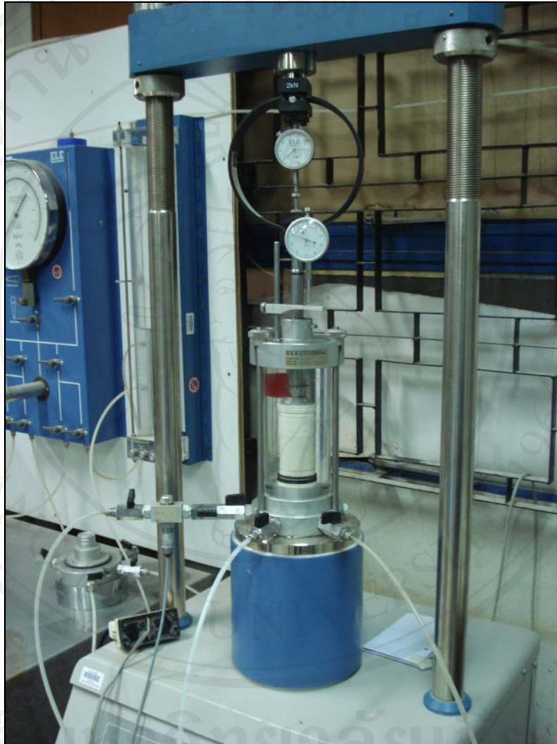
รูป ง-9 ตัวอย่างดินและชุดอุปกรณ์ทดสอบแรงอัดสามแกนในห้องปฏิบัติการ
