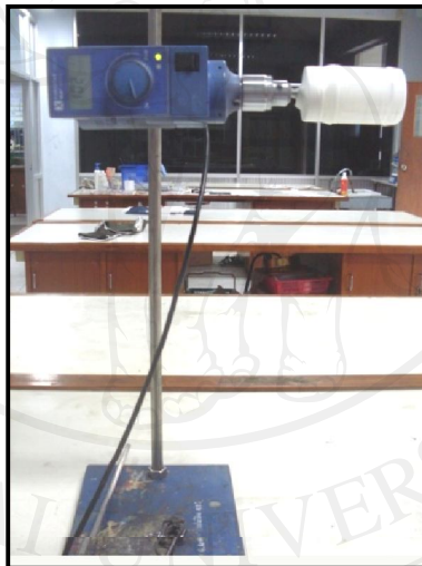
รูป 3.19 การผสมด้วยวิธีทางกล (Mechanical mixing)
