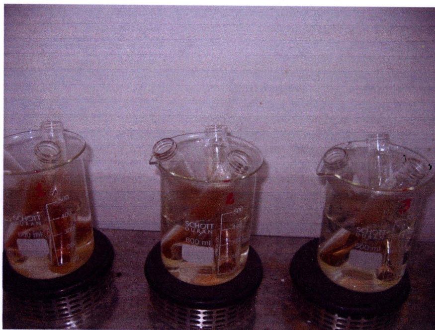
รูปที่ ผ-6 การย่อยสลายตัวอย่างพืชโดยใช้เตาย่อย
