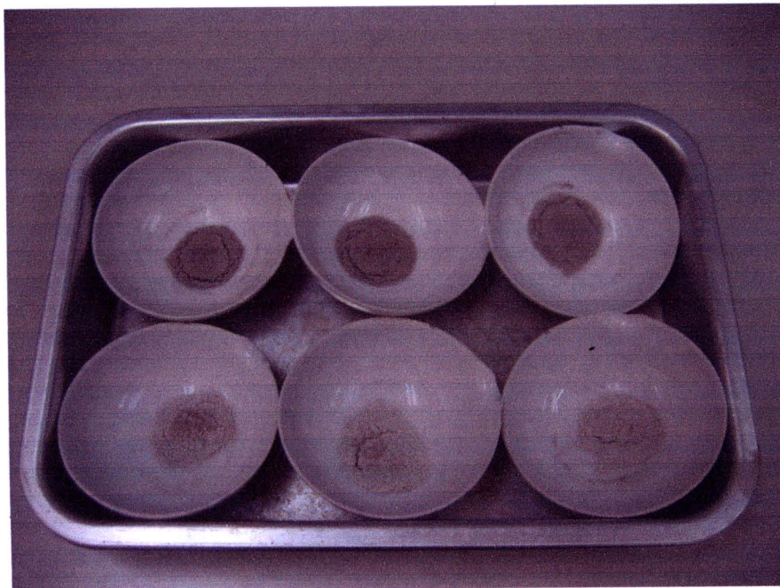
รูปที่ ผ-4 ตัวอย่างพืชหลังจากการเผาที่ 550 °C
