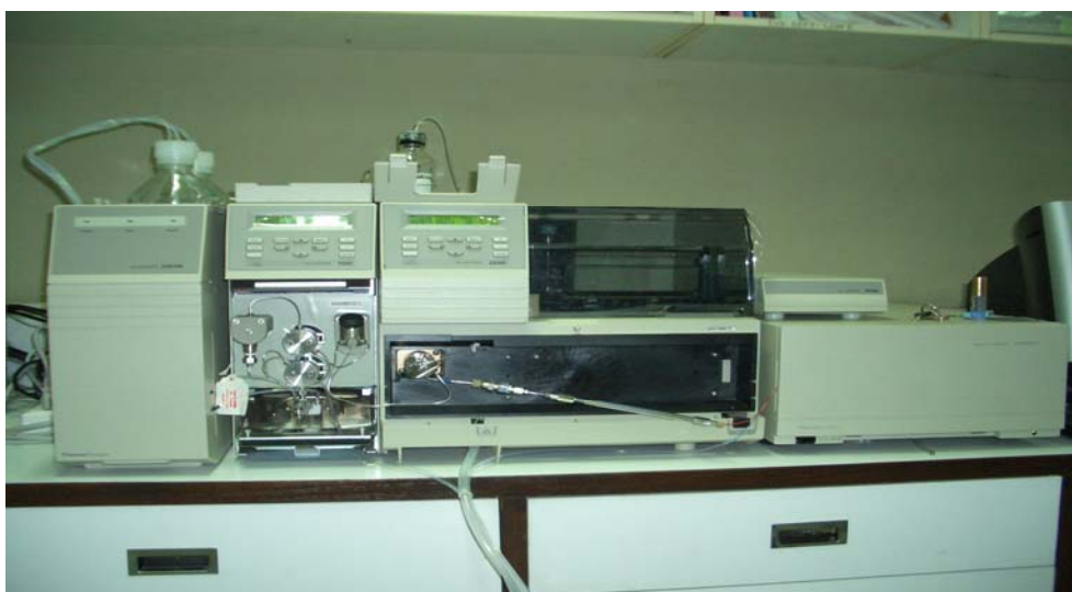
ภาพที่ 10 แสดงภาพเครื่อง High Performance Liquid Chromatography
