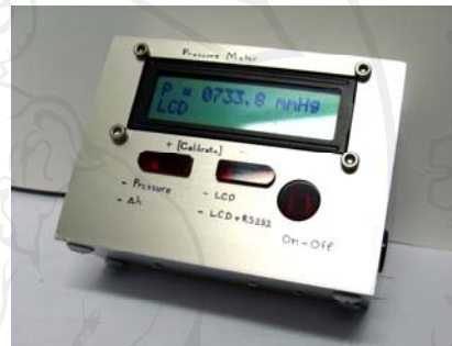
รูปที่ 3.8 รูปซ้ายแสดงโครงสร้างของตัววัดความดันที่ออกแบบไว้โดยใช้แหล่งพลังงานจากแบตเตอรี่ 9V และรูปขวาแสดงภาพถ่ายตัววัดความดันที่ประกอบเสร็จ
