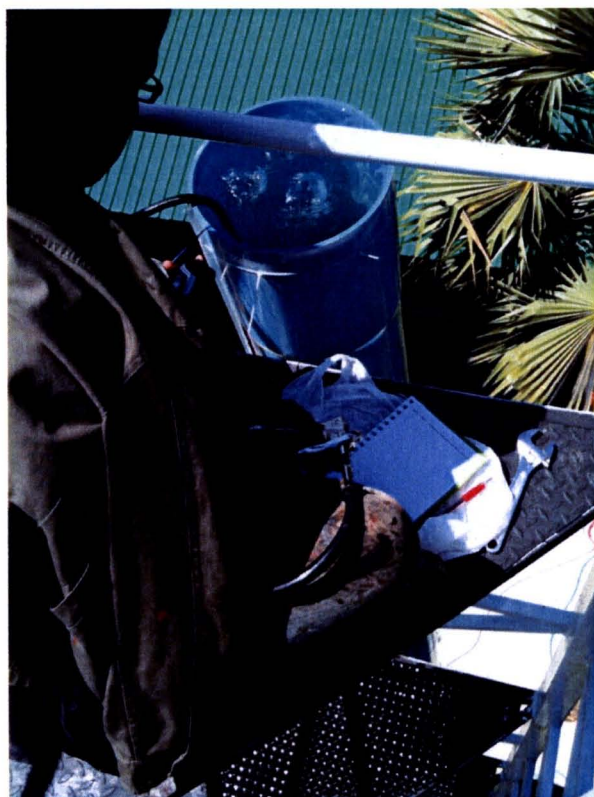
รูปที่ 3.2 การทดสอบหาความเร็วการเคลื่อนที่แนวตั้งของฟองอากาศขนาดต่างๆ
