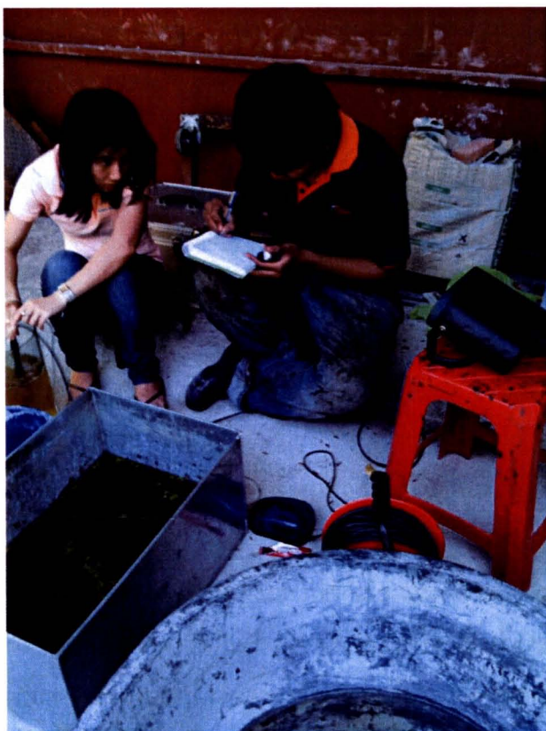
รูปที่ 3.1 การทดสอบความสามารถในการดูดซึมออกซิเจนของน้ำเสียโดยการเติมอากาศ
