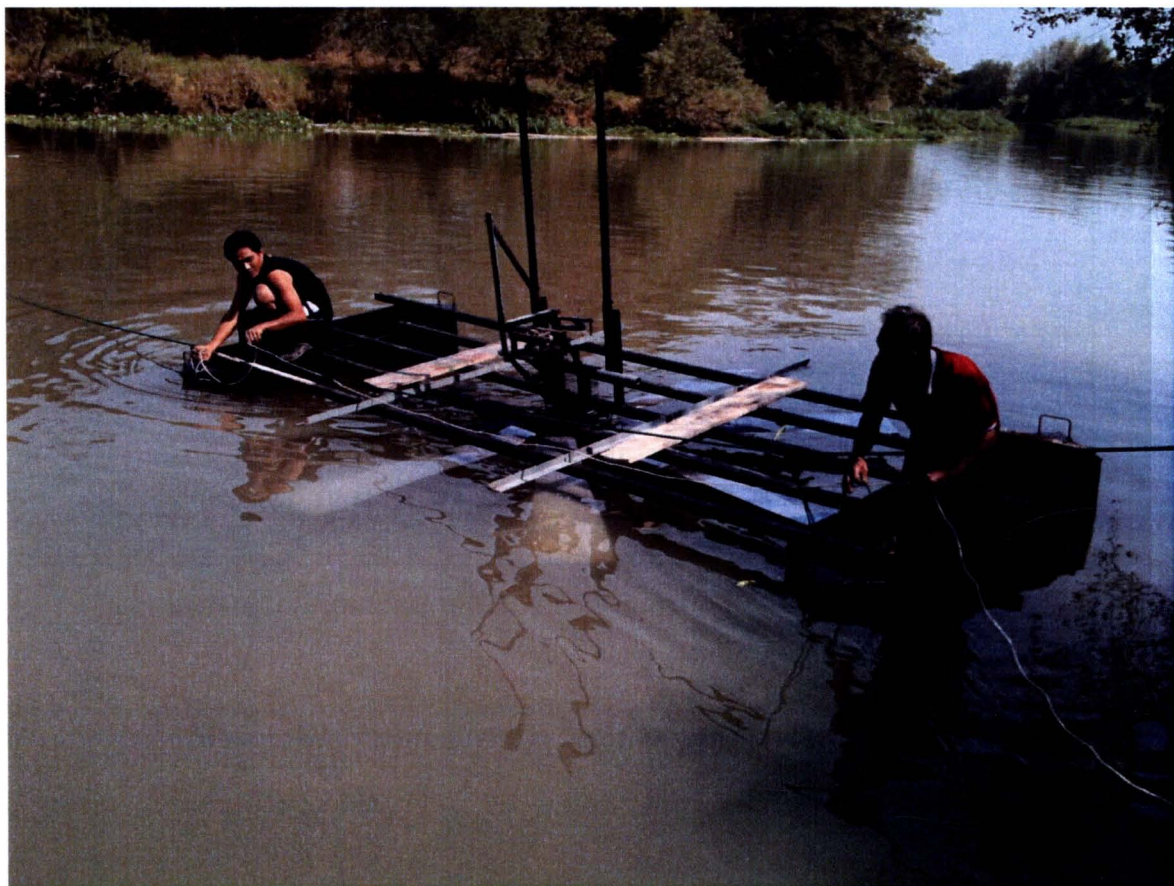
รูปที่ 3.20 การทดสอบประสิทธิภาพของเครื่องปั้มน้ำพลังงานภายในในแม่น้ำ
