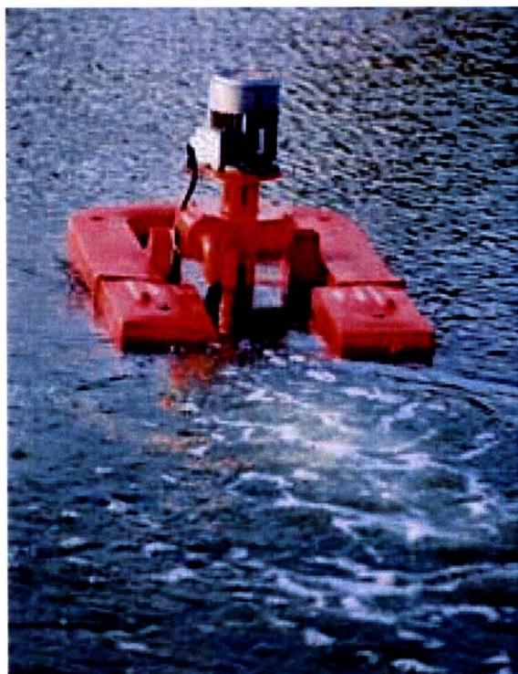
รูปที่ 2.24 เครื่องกลเติมอากาศแบบ RX-5C (มูลนิธิชัยพัฒนา)
