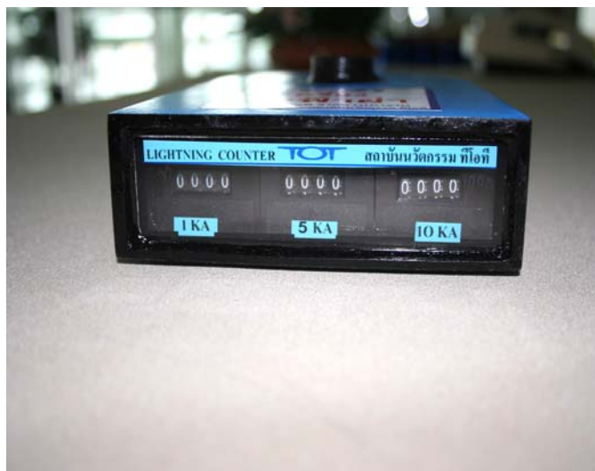
ภาพที่ 53 เครื่องวัดฟ้าผ่าที่ติดตั้งที่ สถานีโทรคมนาคม
