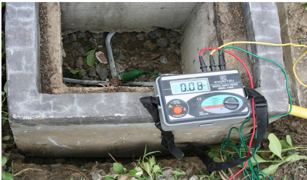
ภาพผนวกที่ 13 เครื่องวัด EARTH TESTER แบบ 3 หมุด
