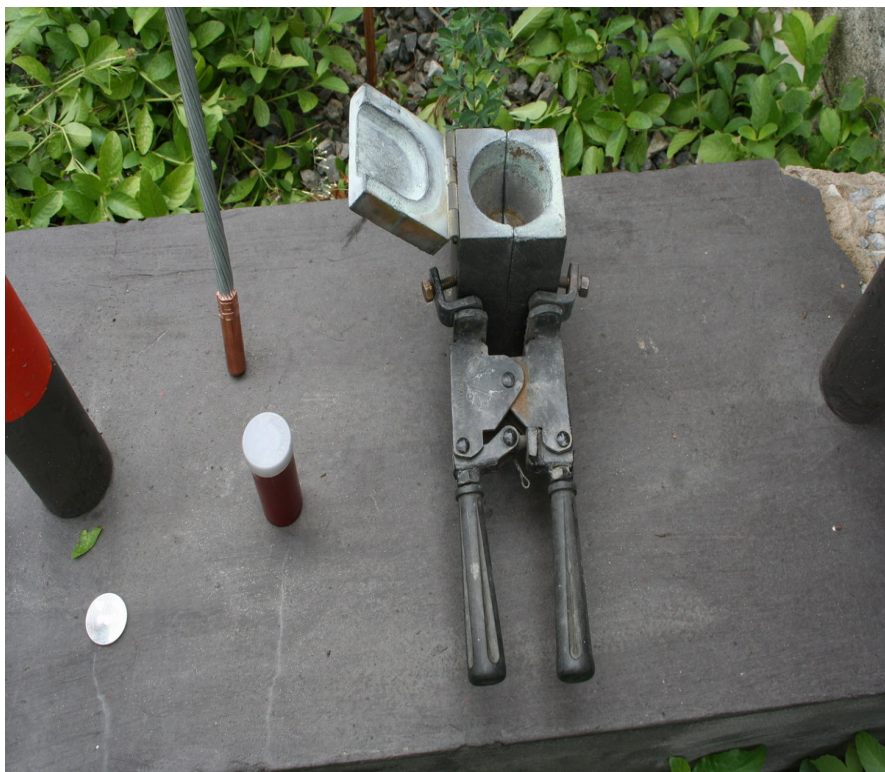
ภาพผนวกที่ 17 อุปกรณ์ที่ใช้สำหรับเชื่อมต่อกราวนด์
