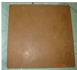
ภาพที่ 16 แผ่นยางปูพื้นต้นแบบ 1 จากการใช้สารเคมีผ่านกระบวนการขึ้นรูปยางพาราผสมกับ ดินกกหรือดินเผลกในอัตราส่วน 1:0 โดยน้ำหนัก
