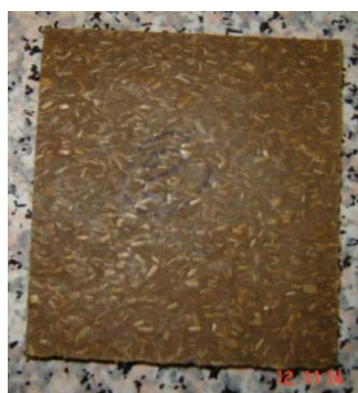
ภาพที่ 17 แผ่นยางปูพื้นต้นแบบ 2 จากการใช้สารเคมีผ่านกระบวนการขึ้นรูปยางพาราผสมกับ ดินกกในอัตราส่วน 1:1 โดยน้ำหนัก
