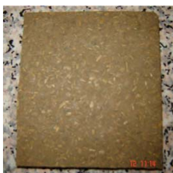
ภาพที่ 20 แผ่นยางปูพื้นดันแบบ 3 จากการใช้สารเคมีผ่านกระบวนการขึ้นรูปยางพาราผสมกับ ต้นแฝกในอัตราส่วน 1:1 โดยน้ำหนัก
