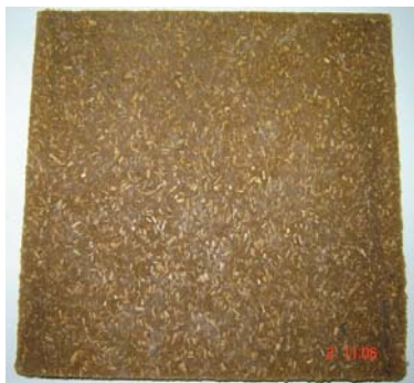
ภาพที่ 22 แผ่นยางปูพื้นต้นแบบ 3 จากการใช้สารเคมีผ่านกระบวนการขึ้นรูปยางพาราผสมกับ ดินแฟกในอัตราส่วน 1:3 โดยน้ำหนัก
