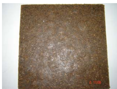
ภาพที่ 18 แผ่นยางปูพื้นต้นแบบ 2 จากการใช้สารเคมีผ่านกระบวนการขึ้นรูปยางพาราผสมกับ ดินกกในอัตราส่วน 1:2 โดยน้ำหนัก
