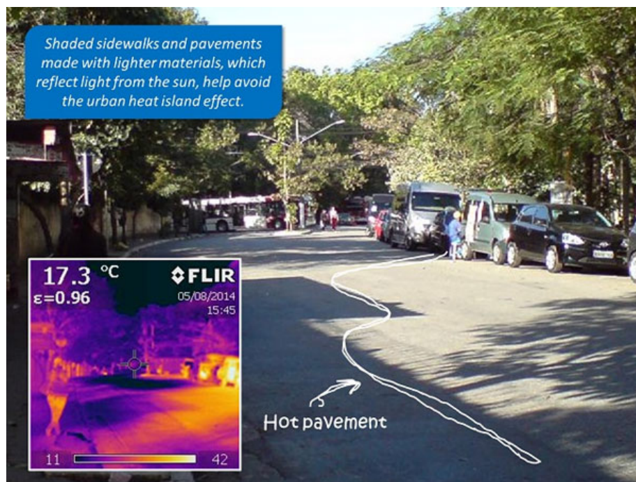
รูปที่ 2.13 ออกแบบเกี่ยวกับวัสดุสะท้อนแสง เพื่อช่วยในการลดผลกระทบเรื่องความร้อนในพื้นที่
