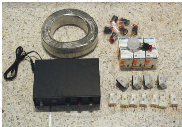
ภาพประกอบ 59 อุปกรณ์ เครื่องควบคุมไฟ ปลั๊กไฟ สายไฟ ขั้วและหลอดไฟ
