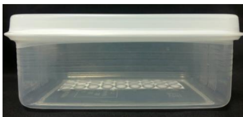
รูปที่ 5 การเก็บรักษาอุปกรณ์ตรวจวิเคราะห์ของไหลจุลภาคฐานกระดาษที่เคลือบด้วย sol-gel ที่มีการ immobilize เอนไซม์ในภาชนะปิดสนิทที่อุณหภูมิ 4 องศาเซลเซียส
