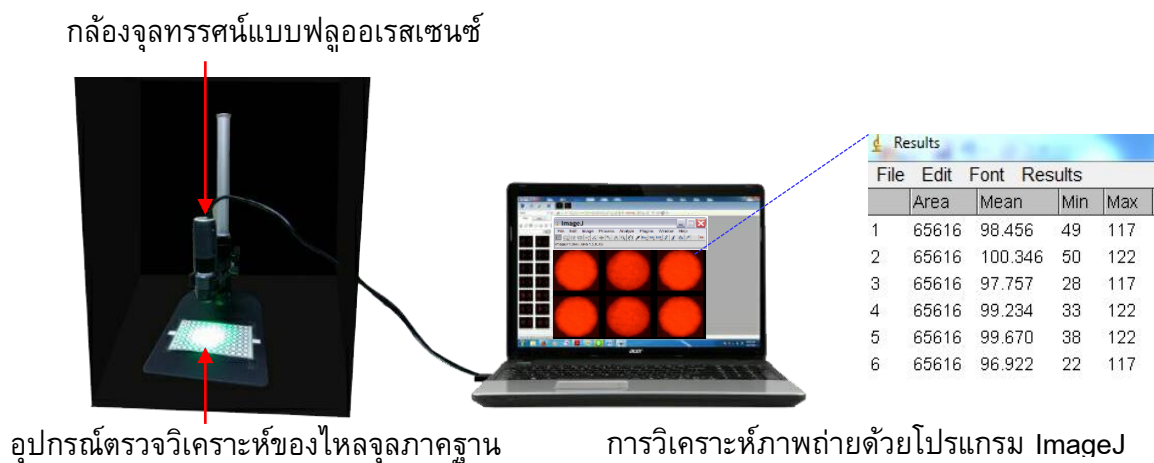
รูปที่ 4 การวิเคราะห์บนอุปกรณ์ตรวจวิเคราะห์ของไหลจุลภาคฐานกระดาษที่ตรวจวัดด้วยการถ่ายภาพด้วยกล้องจุลทรรศน์แบบฟลูออเรสเซนซ์
