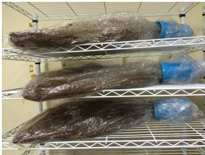
ภาพภาคผนวกที่ จ 1 การขยายขนาดการผลิตเอนไซม์เซลลูเลสในถุงหมักขนาด 200 กรัม
