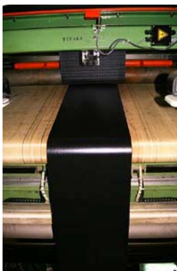
ภาพที่ 2.4 เครื่องฉาบบางลงบนผ้าใบ (Calender Unit) (Tyre Technology International Magazine Annual Review, S.A.I, 1999 )
