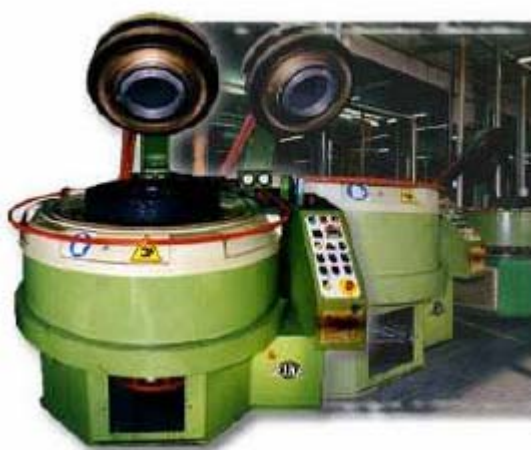
ภาพที่ 2.6 แม่พิมพ์ขึ้นรูปยางและยางที่ขึ้นรูปเสร็จ (สำนักงานเทคโนโลยีความปลอดภัย กรมโรงงานอุตสาหกรรม, 2535)
