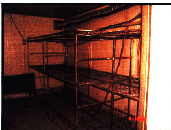
รูปที่ 4.14 ลักษณะตะแกรงในอบแห้งไม้มะม่วงแกะสลักแบบใหม่
