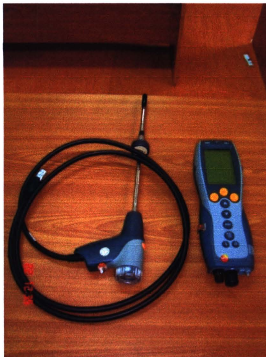
รูปที่ 3.6 เครื่องตรวจวัดก๊าซไอเสียจากการเผาไหม้เชื้อเพลิง
