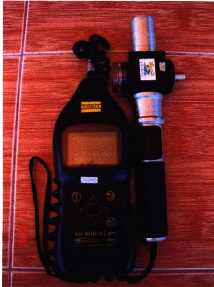
รูปที่ 3.11 เครื่องวัดเครื่องวัดฝุ่นในอากาศ
