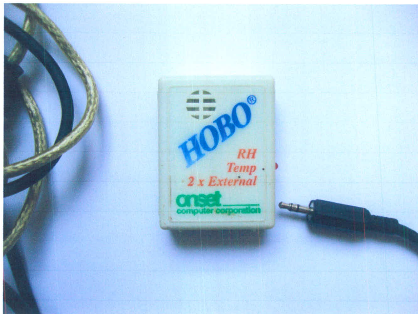
ภาพที่ 3.1 อุปกรณ์ data logger สำหรับเก็บข้อมูลอุณหภูมิอากาศ และความชื้นสัมพัทธ์ ยี่ห้อ HOBO รุ่น multi-channel reusable data logger HO8-007-02
