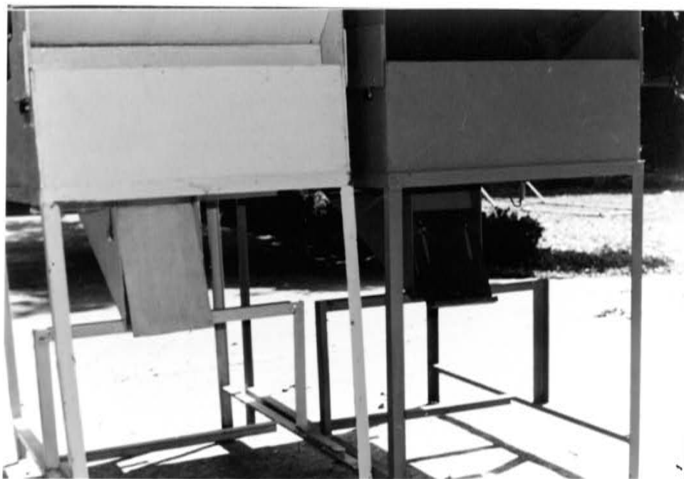
รูปที่ 3.11 การปรับปรุงช่องทางออกเมล็ดไม้สายพาน
