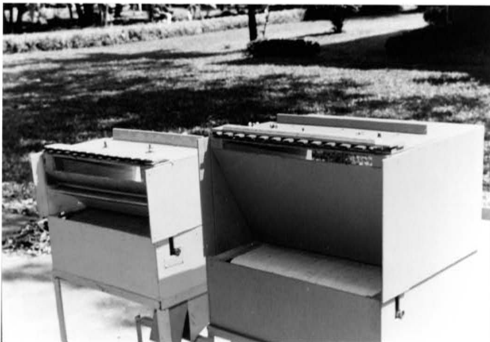
รูปที่ 3.9 การลดขนาดช่องป้อนและเพิ่มขนาดถังป้อนเมล็ดพันธุ์
