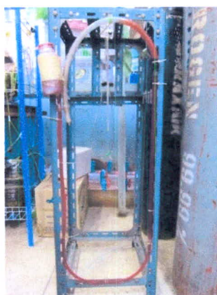
ภาพที่ 3.8 เครื่องวัดปริมาณก๊าซชีวภาพแบบท่อรูปตัวยู
